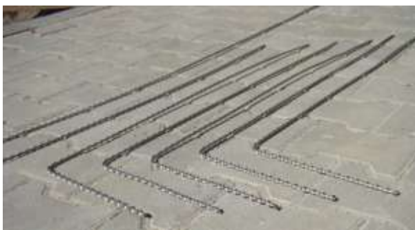
Рисунок 6 – нарезанные стержни Sure Twist и выгнутые под нужным углом.
